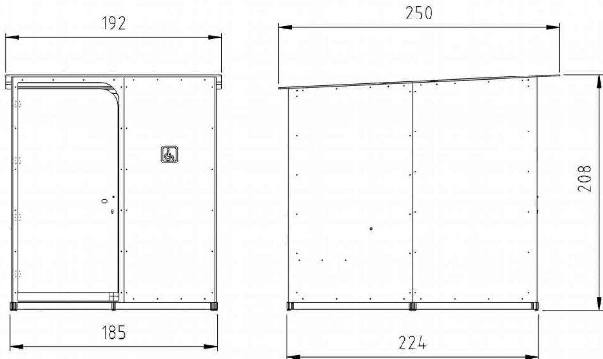
**Hinweis zum Aufstellort:** die Kabine alleine benötigt ~ 4m<sup>2</sup> an Fläche. Im Bedarfsfall kann eine Rampe mit ~ 90 x 130 cm installiert werden. In jedem Fall muss für den Anfahrtsbereich zusätzlich eine Fläche von 150 x 200 cm sichergestellt werden, somit erhöht sich die benötigte Gesamtfläche auf ~ 8m<sup>2</sup>.
